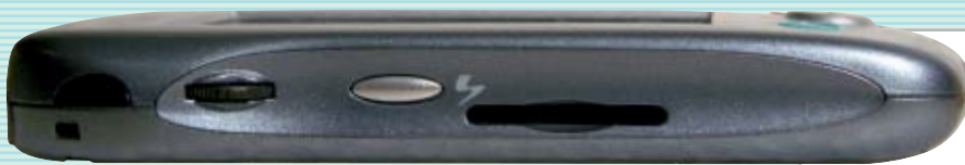
Il lato sinistro del Pocket LOOX 600: lo slot per le schede di memoria SD non è dotato di alcun coperchio o sistema di protezione
